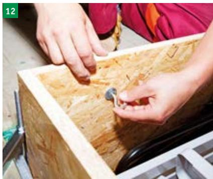
demontáž závěsných ok a zaslepení vzniklých otvorů záslepkami
